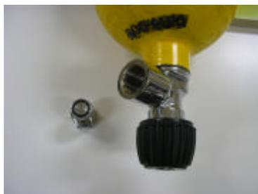
Con el equipo en posición horizontal, deslizar la botella por la correa del soporte de la botella desde la parte superior de la espaldadera, hacia el conector de la botella situado sobre el reductor de presión, y colocar la salida de la válvula hacia la rosca de cierre del mano reductor.
