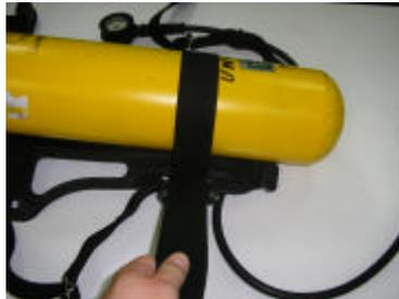
Presionar firmemente la punta suelta de la correa sobre el velcro.
