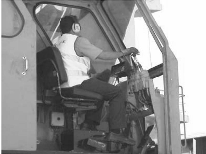
**Cascos anti-ruido:** Son cascos que recubren la oreja, así como una gran parte de la cabeza. Permiten reducir además la transmisión de ondas acústicas aéreas a la cavidad craneana, disminuyendo así la conducción ósea del sonido al oído interno
