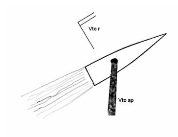
Para el cálculo práctico, en primer lugar se dibuja el rumbo del barco, con el módulo correspondiente a su velocidad. En el extremo del rumbo se dibuja el viento aparente medido a bordo y ya solo queda unir el principio del rumbo con el final del vector del viento aparente.
